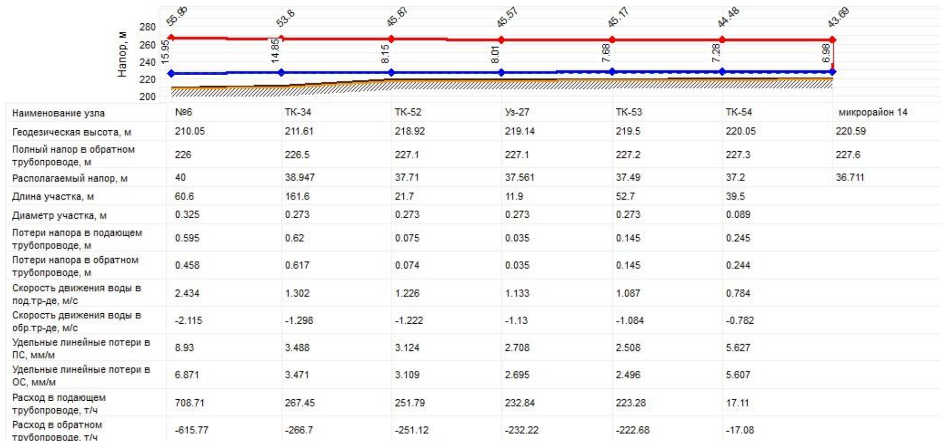
Рисунок 9. Пьезометрический график от котельной №6 до потребителя – жилой дом №3 по ул. Заслонова
